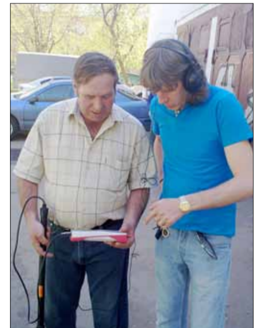
Поиск утечек акустическим методом
