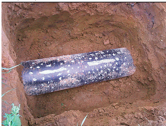
Рис. 8. Выявление участка с внутренней коррозией. Минимальная толщина стенки 6,5 мм, исходная толщина 8,0 мм
