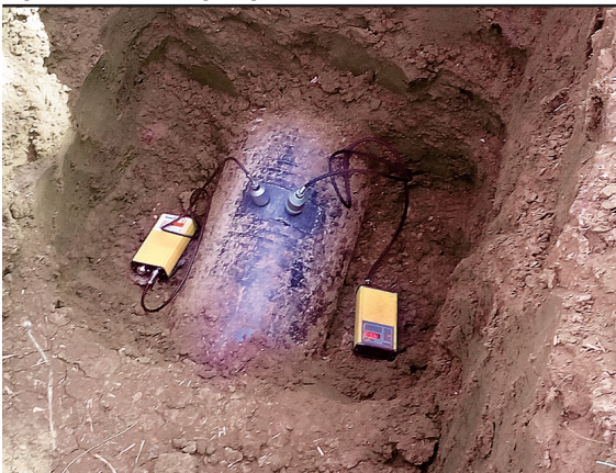
Рис. 4. Проведение АТ-диагностирования на промышленном нефтепроводе
