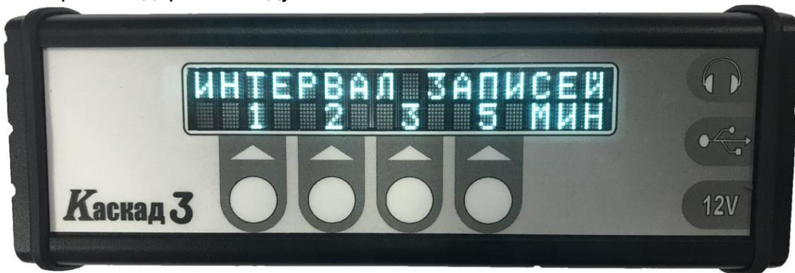
Задать время, необходимое для перестановки датчиков с одной трубы на другую.
